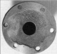
Spaltkorrosion unter einer Dichtung
