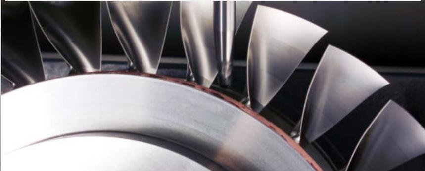
Turbinenrad 1.4313, Fraunhofer-Institut für Produktionstechnologie
